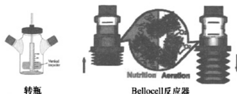
图1 转瓶和潮汐式反应器 Bellocell 工作原理图
