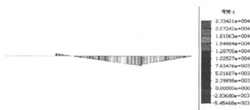
图11 考虑预应力影响的主梁侧向弯矩图
